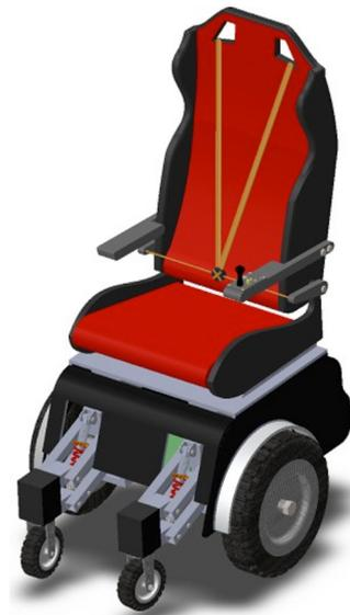
Figura 2. Modelo virtual construido en SW como prototipo final.
